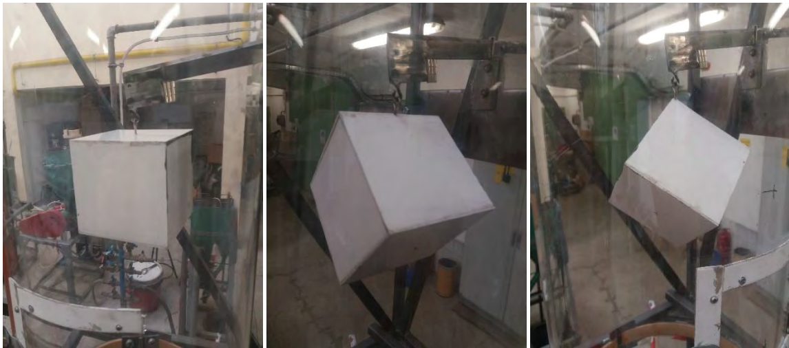
4. ábra: Légsebességgel szemben lapjával, élével és csúcsával mért kockák
